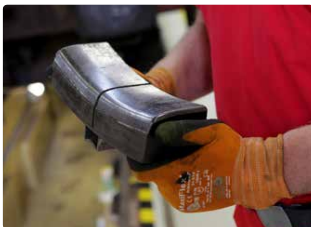
Umrüstung an den Fahrzeugen auf leise Bremssohlen aus Verbundstoffen („Flüsterbremse“)
